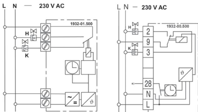
\* ) Примечание: Дополнительные комнатные термостаты с функцией уменьшения температуры могут быть подключены к клемме 28.
